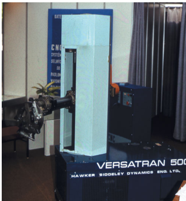
Obr.13 Anglický hydraulický robot VERSATRAN 500 – prvý robot na pedagogickom pracovisku – SJF VŠT Košice
