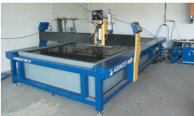
Obr.23 Veľkoplošný technologický systém AQUACUT firmy MICROSTEP GROUP na delenie materiálov vodným lúčom
