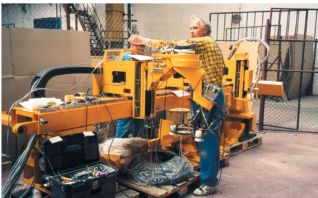
Obr.22 Súčasná výroba veľkoplošných rezacích centier CNC vo firme MICROSTEP GROUP Bratislava, ktoré môžu disponovať aj 6 stupňami voľnosti
