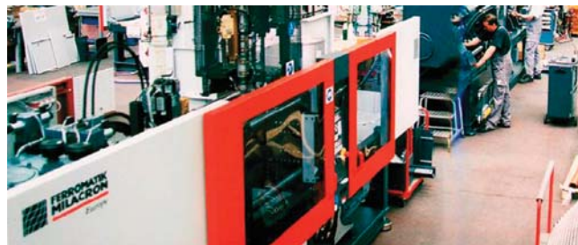
Moderná automatizácia od B&R: plne elektrický vstrekolis na plasty firmy FERROMATIK MILACRON postavený na jednej zbernici – Ethernet Powerlink™
