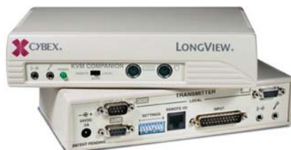
Obr.3 Vysielač a prijímač CAT5 extendera
