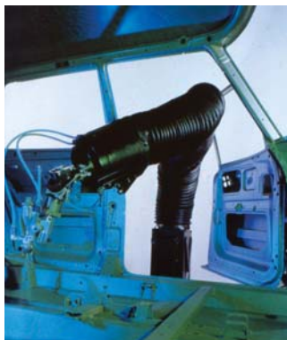
Obr.56 Chobotový striekač mimoriadne flexibilný robot SPINEA firmy ROBOTICS AB pri striekaní vnútorných častí automobilovej karosérie (polovica 80-tych rokov)
