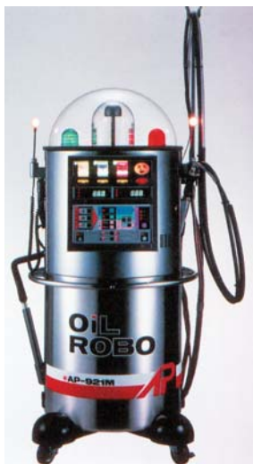
Obr.54 Japonský robot slúžiaci na automatizovanú výmenu motorového oleja
