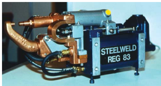
Obr.58 Zváracie kliešte spolu s hydraulickým servopohonom a so zvaracím transformátorom na odporové bodové zvarovanie
