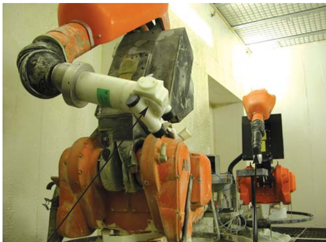
robot IRB 5400-2 s elektrostatickou 2-hlavovou pištoľou od firmy ITW pre touch up nanášanie laku
