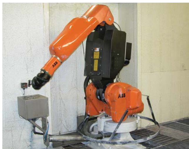
Robot IRB 5400-2 s pneumatickou pištoľou AGMD od firmy ITW na nanášanie druhej a tretej vrstvy farby
