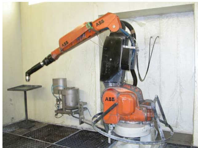
Robot IRB 5400 s elektrostatickým zvonom od firmy Sames na nanášanie prvej vrstvy farby
