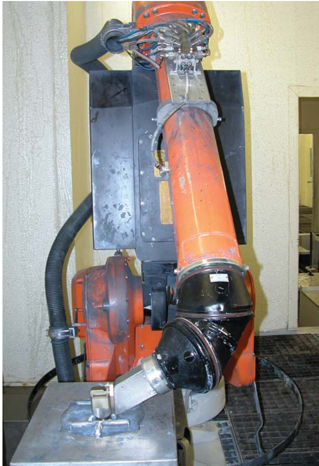
Robot s pneumatickou pištoľou uloženou v čistiacej skrínke na pracovisku striekania podkladovej farby
