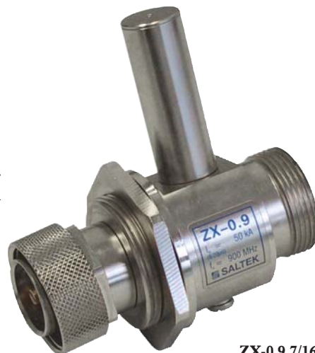
ZX-0,9 7/16 – koaxiálna bleskoistka (štvrtvlnný skrat) na ochranu GSM stanice
