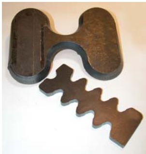
Obr.69 Šikmé plazmové rezanie ocele s hrúbkou 13 mm – MICROSTEP GROUP (r. 1999)
