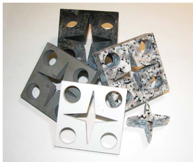
Obr.68 Produkty rezania vodným lúčom
