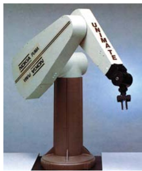
Obr.63 Špičkový montážny robot americkej firmy UNIMATION (NOKIA) z 80-tych rokov
