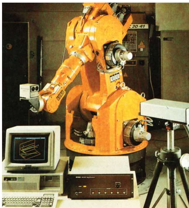
Obr.61 Testovanie presnosti robota pomocou vizuálneho systému a PC
