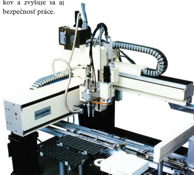
Obr.62 Precízny montážny kartézsky robot ACCUSEMBLER TM japonských firiem SEIKO-EPSON
