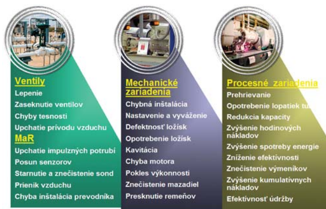
Obr.1 Základné poruchy automaticky monitorované systémom AMS
