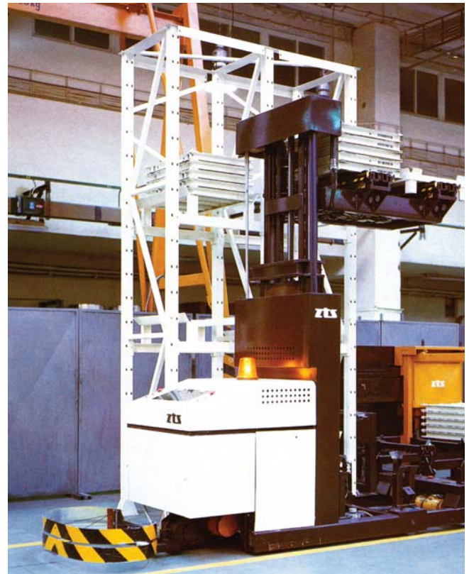
Obr.74 Indukčne vedený robocar ZTS s výsuvnými plošinami (r. 1990)
