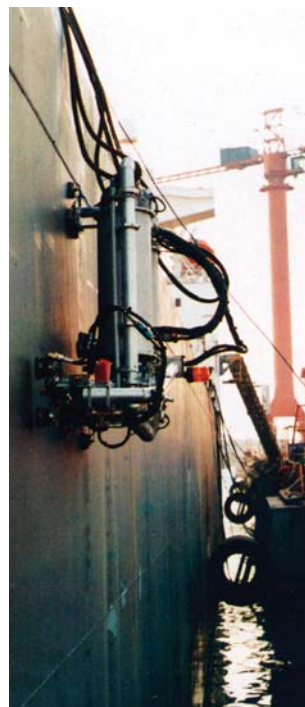
Obr.72 Francúzsky nohový čistiaci robot vonkajších plášťov lodí MARIN RM-2
