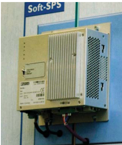
Obr.1 Riadiaci modul S-Max5000 kombinuje v sebe vlastnosti a funkcie PLC, IPC a riadiaceho člena priemyselnej zbernice
