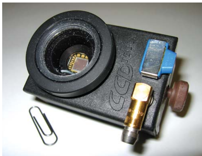
Obr.87 Prvá čs. ČB CCD kamera (bez objektívu) TESLA PTK 0256 (r. 1984)
