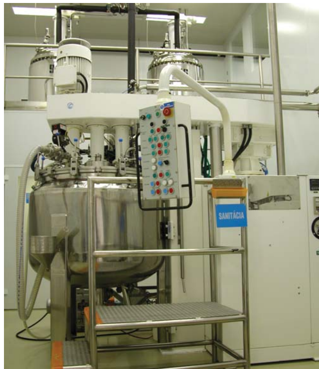
Ovládanie homogenizačného zariadenia
