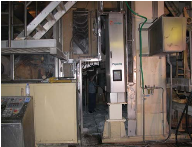
Pohľad na rám senzorov QCS umiestnených za valcom Yankee
