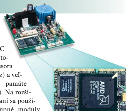
Príklad využitia modulu DIMM-PC v aplikačnej doske
