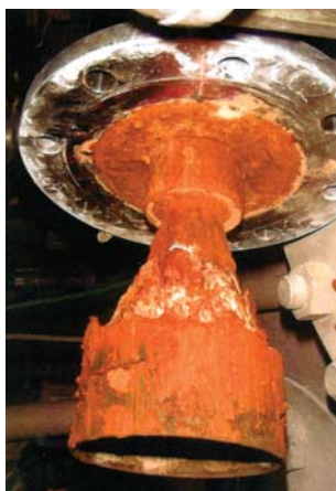
Zabudovaný do zariadenia na výrobu dioxidu titánu poskytuje impulzný radarový merací prístroj výšky hladiny spoľahlivé merané hodnoty aj napriek extrémnym usadeninám na lievikovitej anténe
