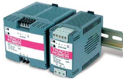
lištu systémom Snap-on. Pripojenie je riešené pomocou zasúvacích skrutkovačích svorkovníc alebo svorkovníc typu Cage Clamp. Ďalšie parametre: vstupné napätie v širokom rozsahu 85 – 264 VAC, výstupné napätie jemne nastaviteľné 12 V, 24 V a 48 V, výstupný signál na indikáciu správnej činnosti meniča, pracovná teplota v rozsahu -10 až +70 °C. Meniče TCL sú vhodné na paralelné spojenie meničov.
