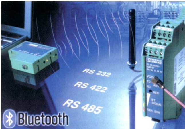
Obr.3 Pomocou konvertora Bluetooth typu PSI-WL sa možno vzdať dátového kábla
