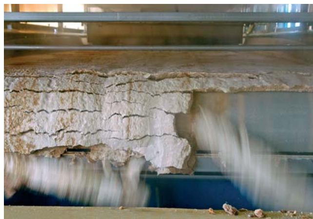
Fáza izolácie treonínu – separácia matečných lúhov
