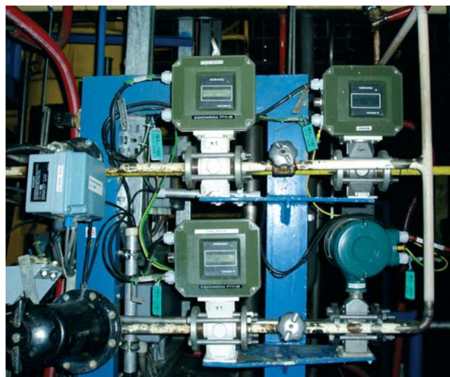
Indukčné dávkovacie prietokomery na dávkovanie príkrmov vo fáze fermentácie od spoločnosti Yokogawa
