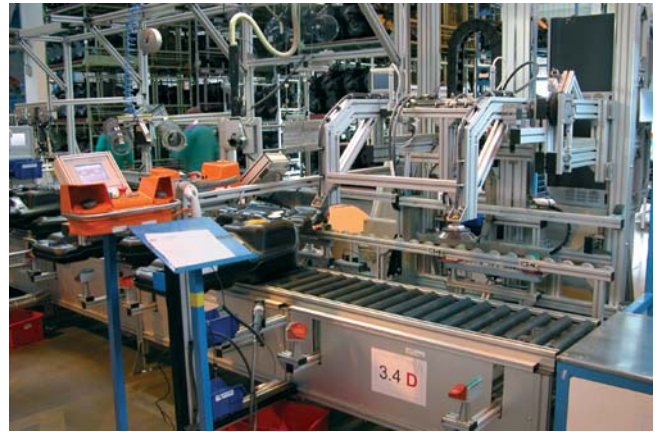
Pracovisko testovania plavákov montážnej linky nádrže Audi Q7
