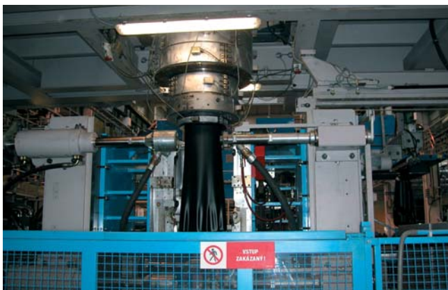
Rukáv vytekajúci z hlavy a pohyblivý vagón prvého lisu
