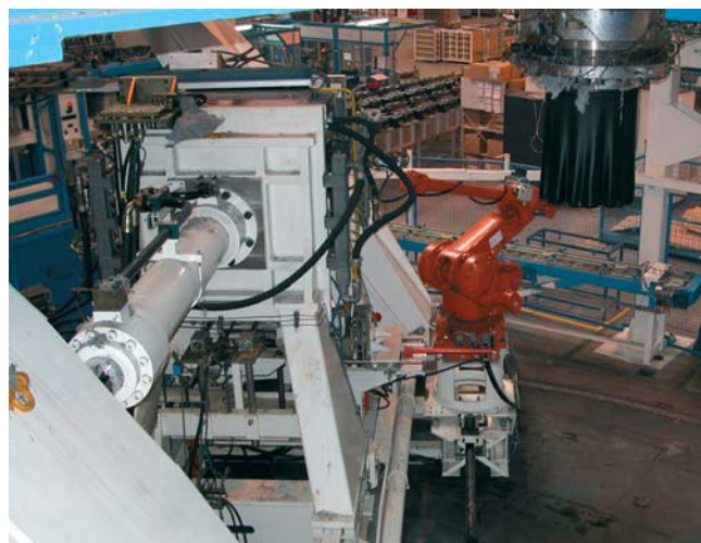
Celkový pohľad na druhý lis – robot čaká na otvorenie formy
