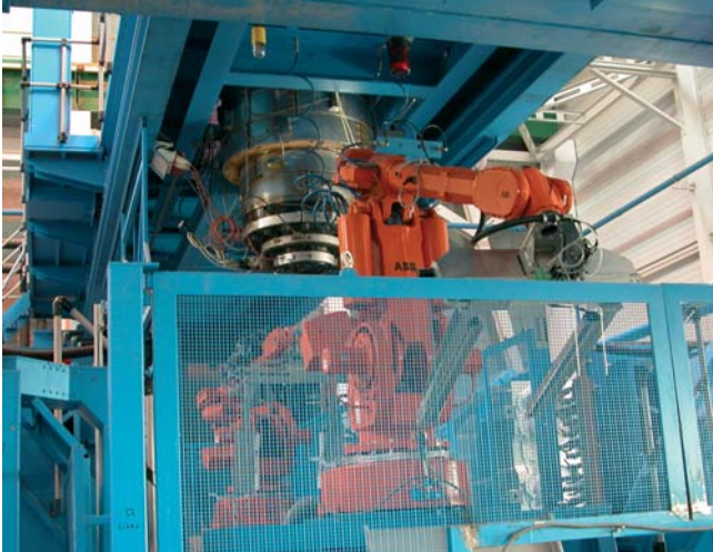
Robot odoberá nádrž z formy tretieho lisu
