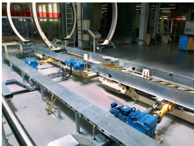
Obr.3 Prekladacia stanica z vystreďovacej zdvižnej plošiny na pásové dopravníky. Úsek utesňovania zvarov, motorprevodovka radu BK20 s výkonom 0,75 kW so zabudovanou brzdou, konektorom a spojenými kotúčmi nasadzovaných za tepla
