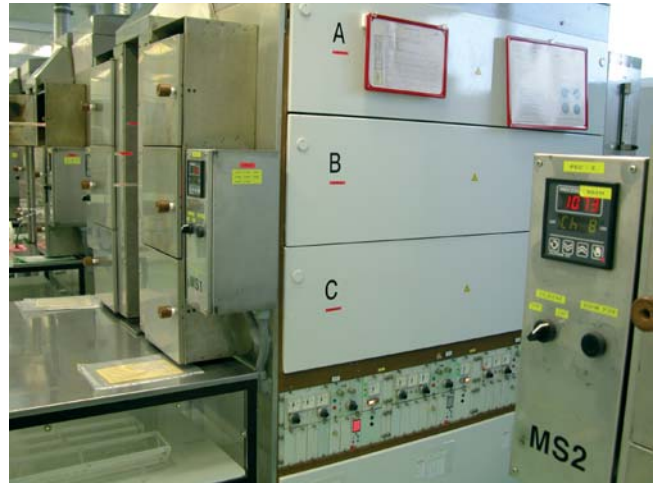
Difúzna pec DA62 s tyristorovou reguláciou a záznamníkom teploty fy. Thermoprozess
