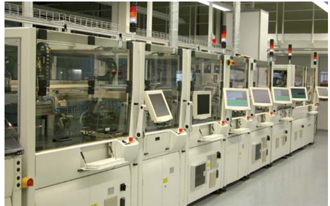
Automatická linka na meranie a triedenie výkonových modulov SEMITRANS
