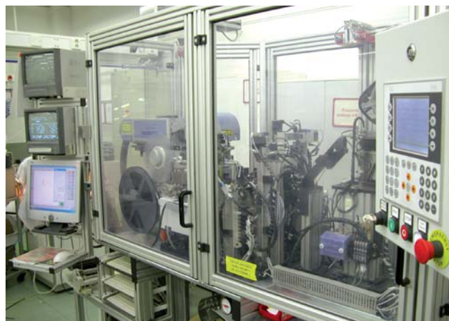
Meračí a baliaci automat pre diódy v puzdre SMA od fy. KOMFI, s riadením od fy. B&R
