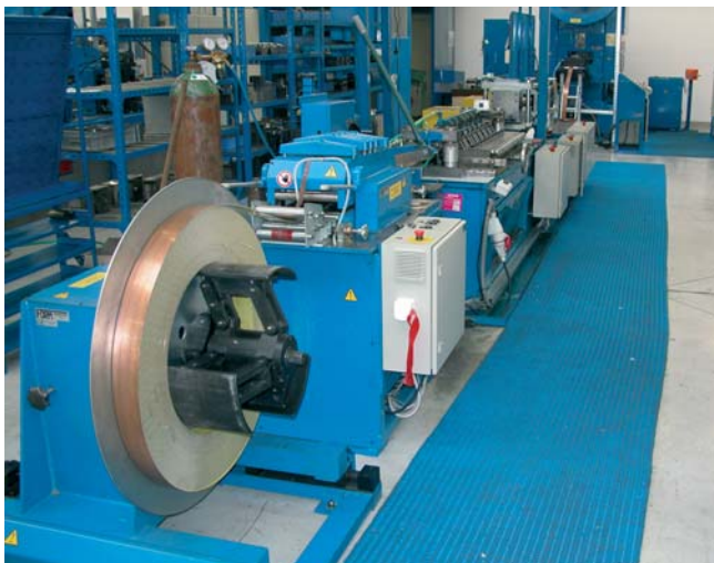
Linka Hoesler – spredu dozadu je vidieť odvíjanie a vyrovnávanie pásu, zrážanie hrán, kalibrovanie a strihanie v lise
