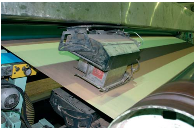
Skenovacia hlava, ktorá monitoruje profil čerstvo vyrobeného papiera
