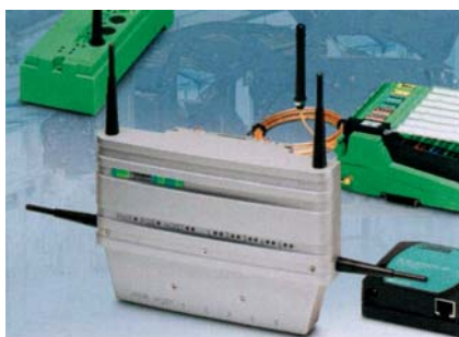
Obr.1 Prístupový bod WLAN Access Point v priemyselnom vyhotovení
