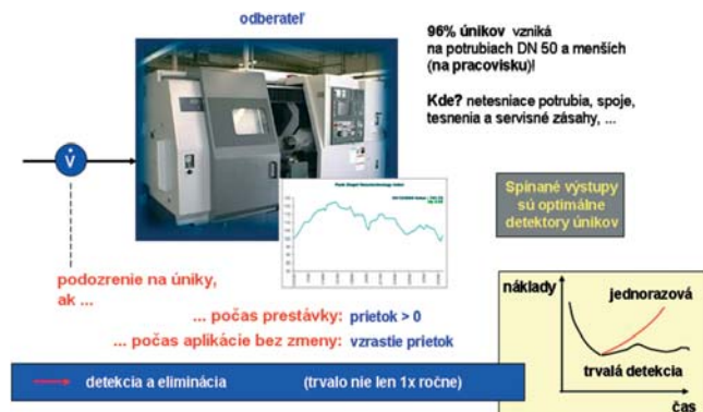
Obr.4 Použitie testo 6440 na znižovanie únikov pred každým strojom
