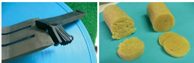
Porovnanie štruktúry rezu klasickým nožom a ultrazvukovým nožom
