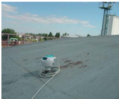
Radarové meranie výšky hladiny v melasovej nádrži
