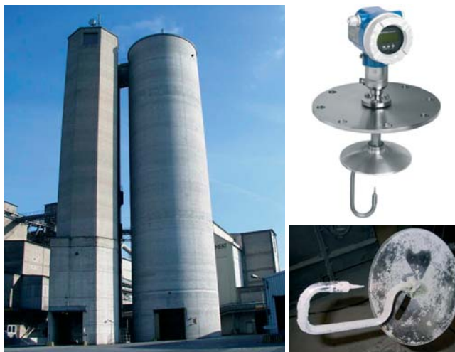
Obr.3 Meranie hladiny v cementárni pomocou radarového snímača Micropilot
