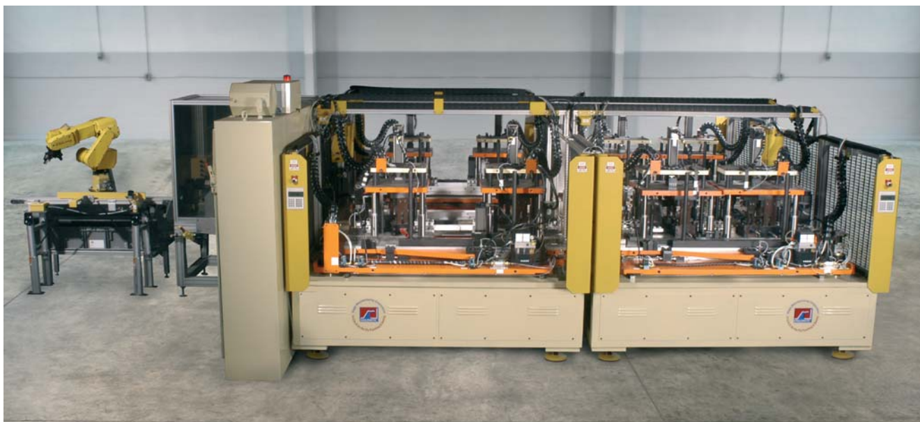
Obr.1 Vytlačovací lis na výrobu profilových tesnení pre automobilový priemysel
