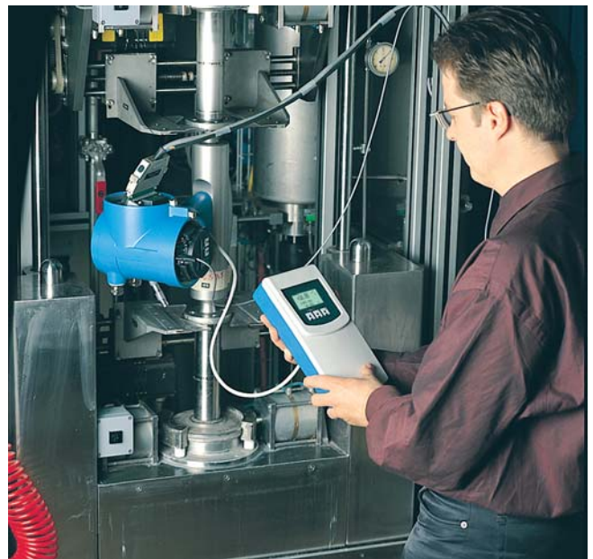
Obr.5 Verifikácia prietokomerov pomocou FieldCheck™ na mieste merania
