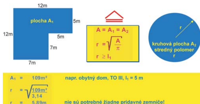
Obr.3 Zemnič typu B – výpočet stredného polomeru
