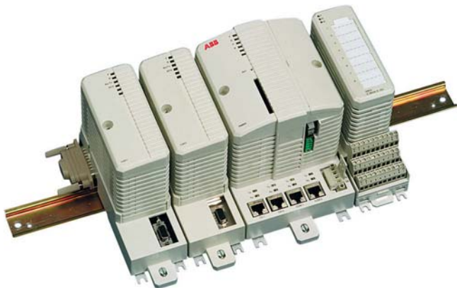
Obr.1 Riadiaci systém AC 800 M generácie IndustrialIT
