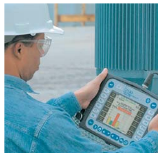
Obr.2 Analyzátor stavu rotačných strojov CSI 2130
