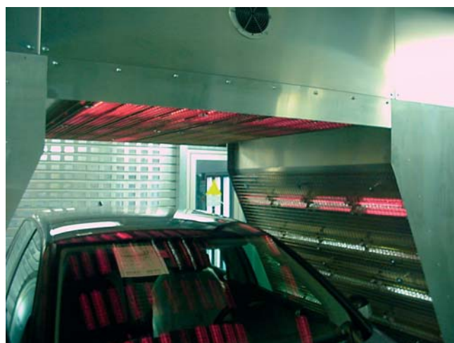
Vypaľovanie laku karosérie vypaľovacím portálom
