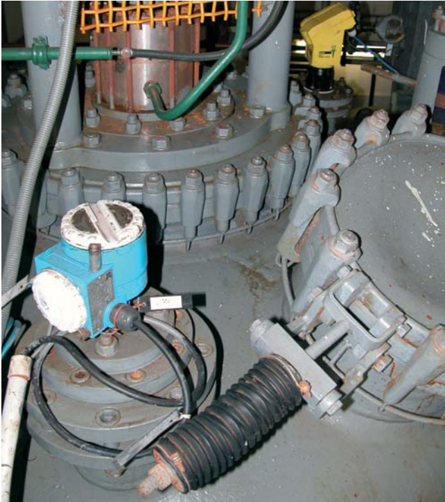
Meranie vodivosti a výšky hladiny na reaktore
