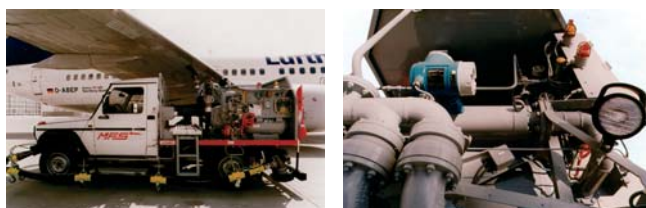
Obr.5 Tankovanie lietadiel pomocou Promass F z automatického dispenzora v zahraničí. Na slovenských letiskách sa prietokomery Promass F používajú na bilančné merania kerozínu
