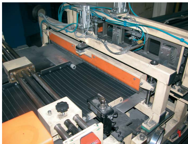
Posuvná časť spájacieho zariadenia s pridržiacou kefou
