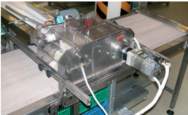
Servomotor Siemens IFK7 poháňaný meničom Simovert MC na priehradkovom dopravníku za balíčkami na dopravnej linke DC M-Joy
