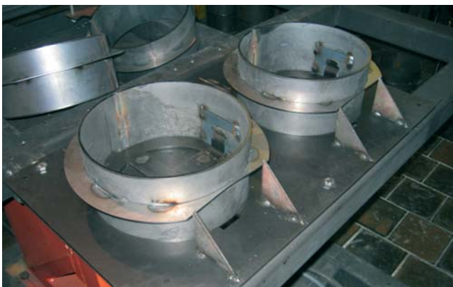
Detailný pohľad na otočný stôl so zvarencami
