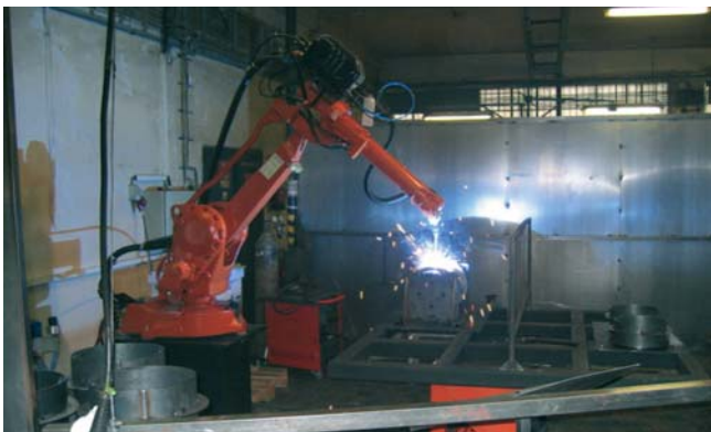
SmarTac senzor umožňuje robotu vopred si zvarenc „ohmatať“
