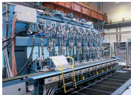
Stroj na tvarovanie skla IS najnovšej generácie so 49 ovládanými pohybovými osami je riadený systémom Simotion D
