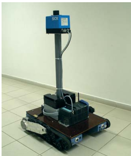
Obr.9 Robocar s laserovou navigáciou – funkčný vzor vyvinutý s podporou agentúry pre vedu a výskum
