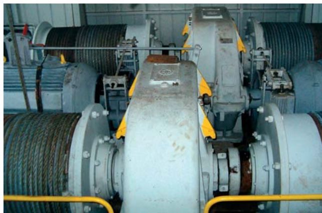
Zdvihové motory, brzdy s prevodovkami a navijacími bubnami
