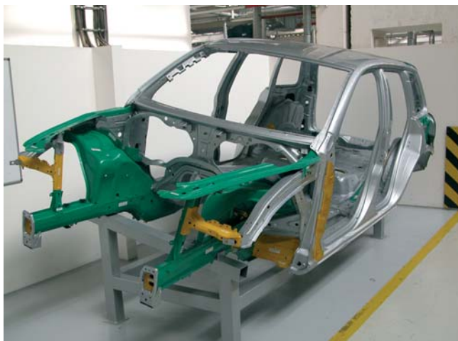
Kostra VW Touareg s vyznačenými farebnými dielmi, ktoré sú vyrobené v Toweri Automotive
