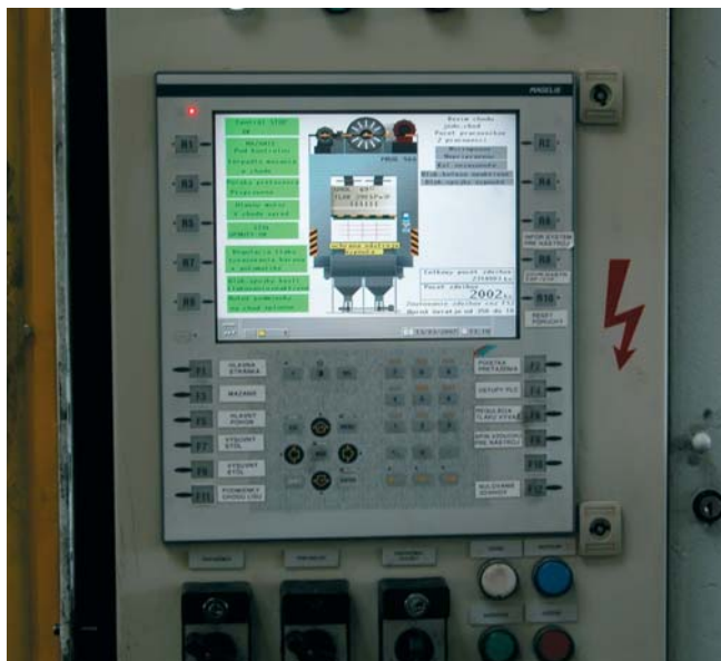
Interaktívny operačný panel Magelis zobrazujúci všetky potrebné informácie pre pracovníkov, údržbu i nastavovačov
