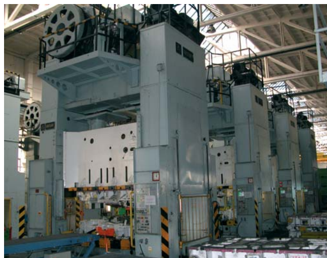
Prvé štyri zo zmodernizovaných 500 tonových tvárniacich lisov vo veľkej lisovni
