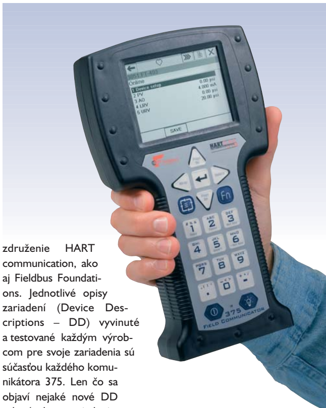
Obr.4 Komunikátor 375 je s podporou viac ako 1 000 zariadení de facto štandardom v oblasti ručných rozhraní
