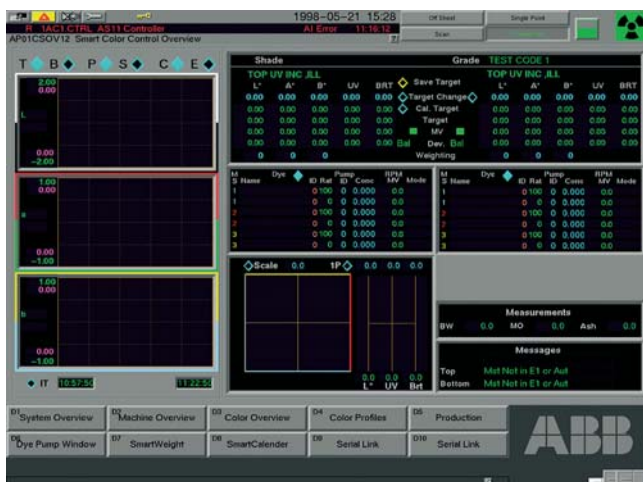
Obr.2 Color Control Overview – prehľadné, presné a aktuálne informácie z meracích zariadení ABB pre celkové riadenie farebnosti
