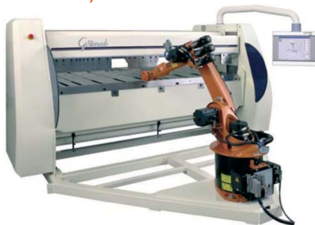
Obr.1 Ohraňovací lis vybavený riadiacim a vizualizačným systémom Prolink môže byť obsluhovaný priemyselným robotom
