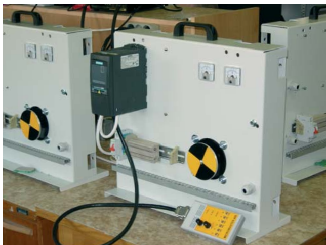
Skúšobný stend – frekvenčný menič MM 440 s ovládacím panelom
