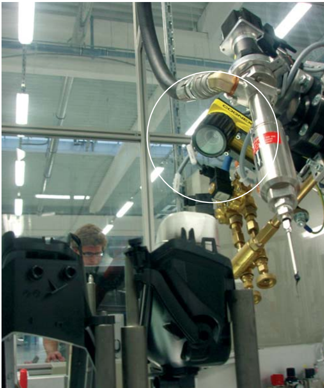
Kontrola správneho zloženia dielu svetlometu kamerou COGNEX
