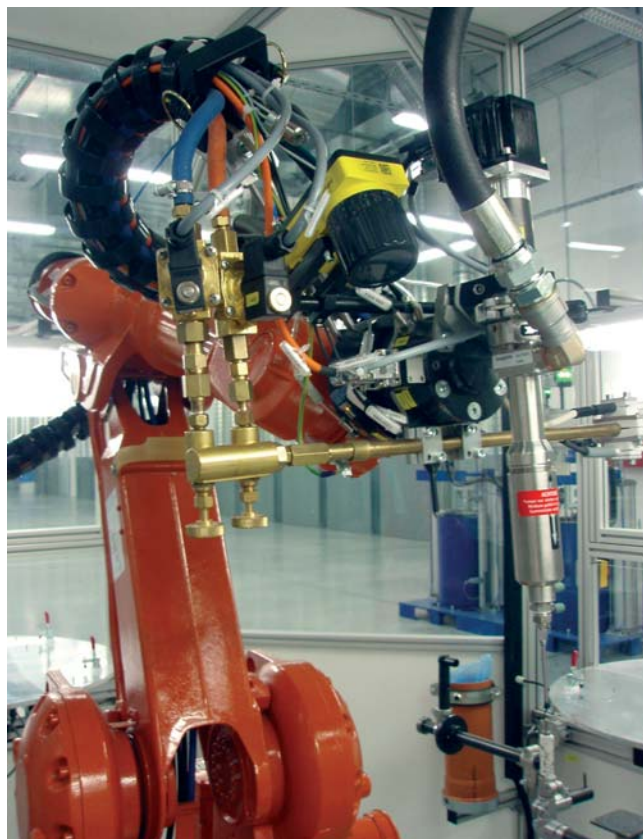
Pohľad na nástrojovú hlavu zľava – kamera COGNEX, horák a dávkovacia dýza VISCOTEC
