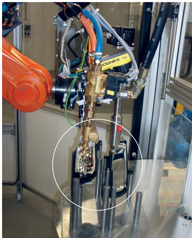
Nanášanie lepidla na okraj dielu svetlometu
