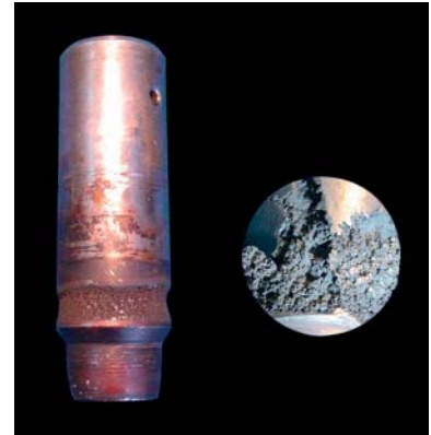
Obr.3 Kuželka poškodená kavitáciou
