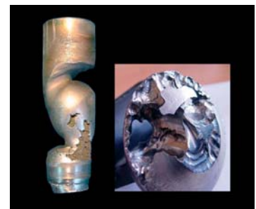
Obr.4 Kuželka poškodená flashingom
