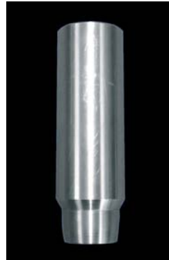
Obr.2 Štandardná neporušená kuželka
